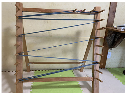
整経台（せいけいだい）という道具を使って、経糸の長さが均一になるように糸束をつくる。
