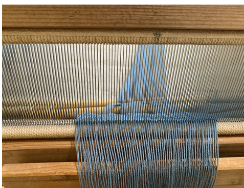
整経（せいけい）した糸を1わずつ、筵（おさ）という部分に通す。緯糸をかけたときに、緯糸を手前に詰める動きをする。
