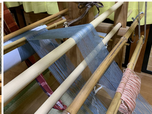
機（はた）に糸をかけた状態。正常に「綾が来る」か確認作業をおこなう。こちらは失敗作。正常に動いている機と見比べて、棒を挿す位置を替えたら「綾が来る」状態になったので、ほっとひと息。
