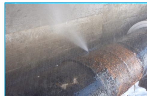
老朽化した水道管からの漏水
