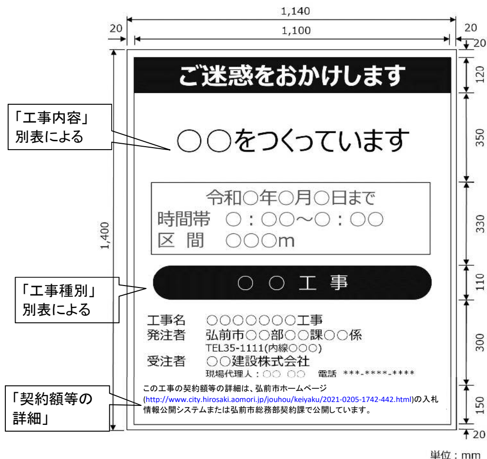
工事名標示板（記載例）
