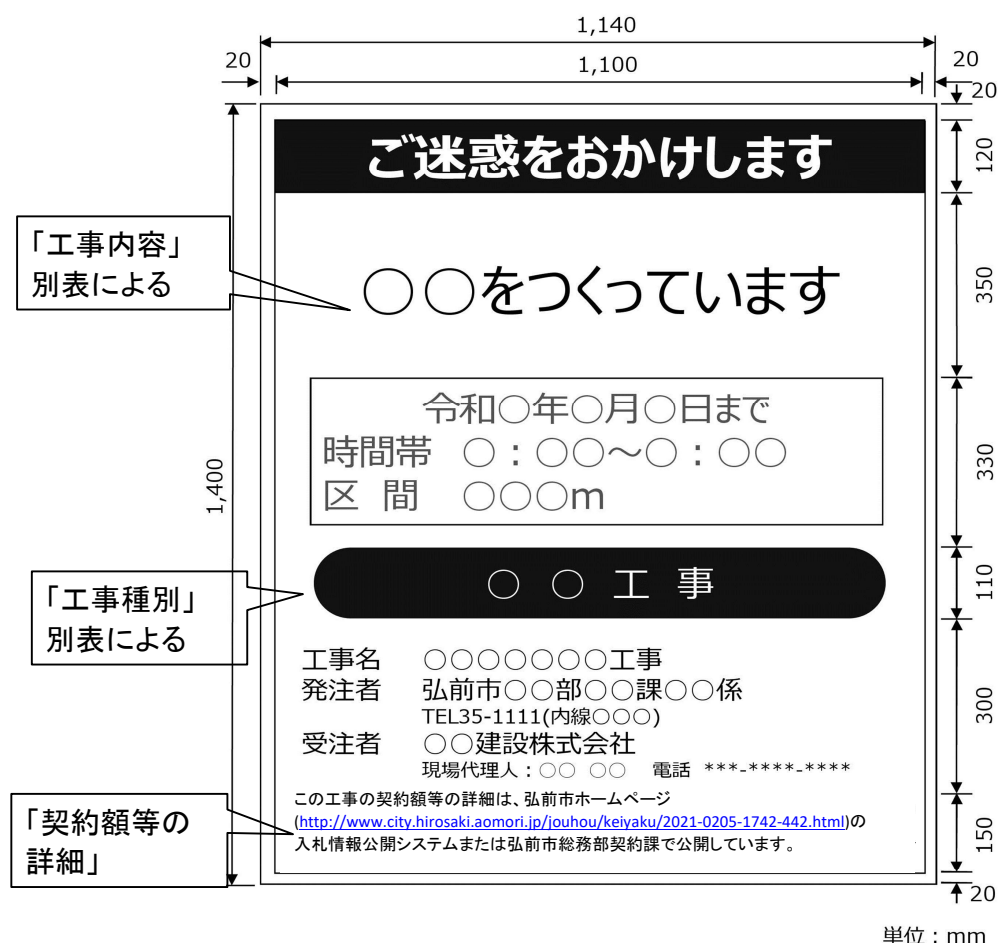
工事名標示板（記載例）
