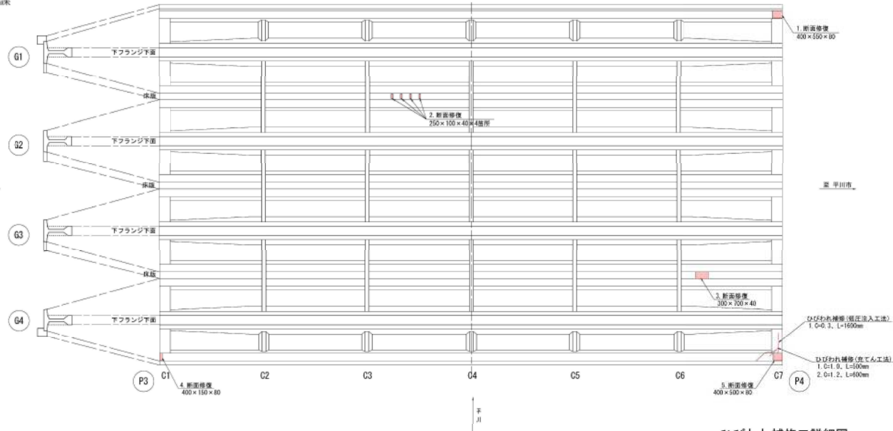
ひびわれ補修工詳細図 No Scale (充てん工法、ひびわれ幅1.0mm以上)
