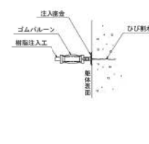
ひびわれ補修工詳細図 No Scale (低圧注入工法、ひびわれ幅0.2mm~1.0mm)
