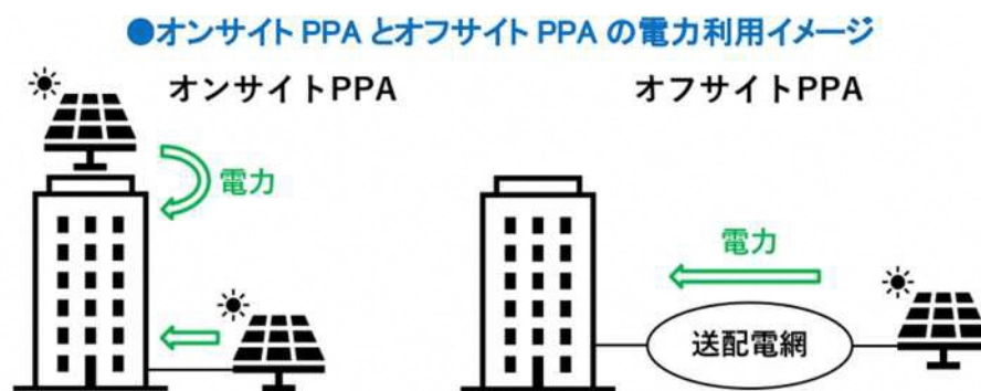
図 8-31 オンサイトPPA とオフサイトPPA の電力利用イメージ 出典：自然エネルギー財団「コーポレートPPA実践ガイドブック」
