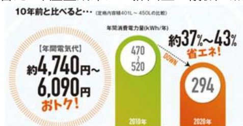
図 8-3 消費電力量の10年前との比較 出典：環境省 デコ活ホームページ
