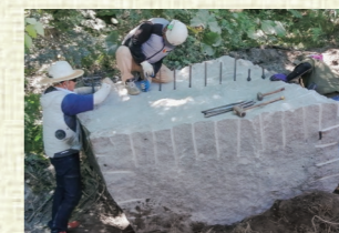
（※3）調達した石材の粗割り作業
