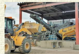
（※7）破砕機で角礫に加工
