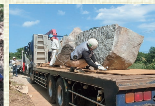
（※4）粗割りした石材の運搬
